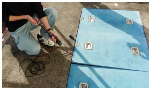
農業集落排水污水处理施設において、硫化水素濃度を測定しました。コンクリート防食劣化なども懸念されるなか、恒久的に健全な污水处理施設維持と農村における生活雑排水処理が安定的に行えるよう、調査業務の一環として実施しました。また各処理工程における水質調査も行い、外部放流時には適正な処理水であることも確認しました。
