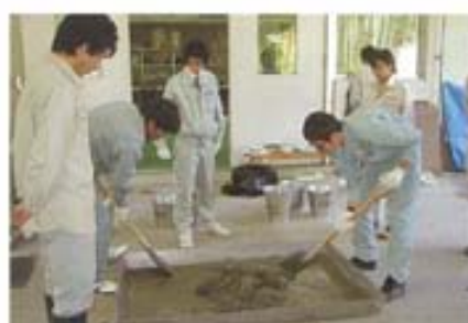
実習：コンクリート配合試験
